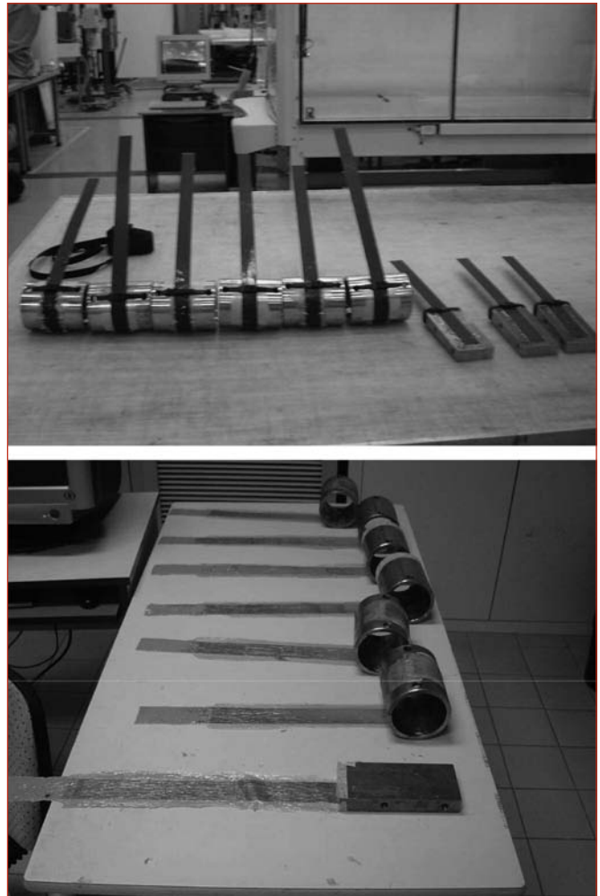
Figure 12 : Photo des joints collés réalisés avec empilements d'UD pré-impregné avec une résine polymérisant à chaud à gauche, et tissu imprégné de résine polymérisant à froid à droite.
