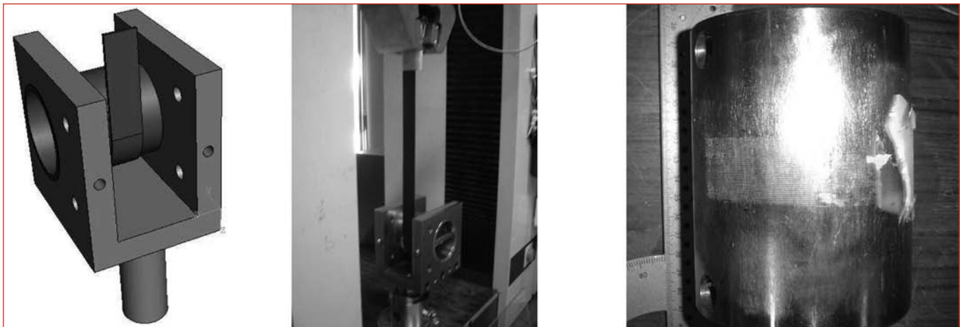
Figure 13 : De gauche à droite : Schéma du dispositif d'essai, photo d'un essai, photo d'une éprouvette après rupture montrant le marquage de l'acier dans la zone de frottement.
